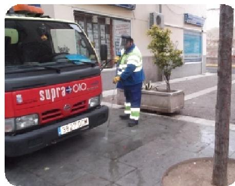
El baldeo mixto es utilizado para una limpieza más exhaustiva en lugares donde no es suficiente sólo el uso de agua a presión. El equipo está formado por cisterna de riego y baldeo, 1 conductor y 1 peón.
